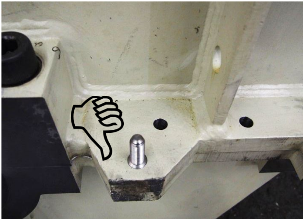
Abbildung 13 Einbrandstelle, konstruktive Anbindung der Nabe schlecht
