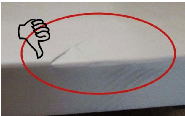
Abbildung 15 Materialeindrücke oder Beschädigungen
