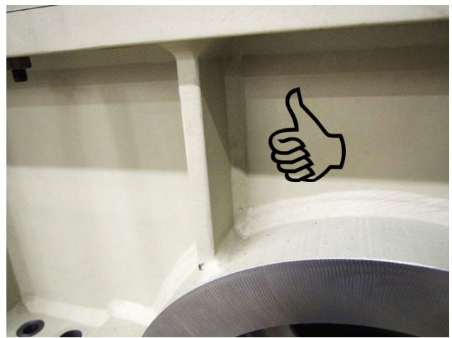
Abbildung 4 Verrippung und Nabe gleichmäßig angebunden
