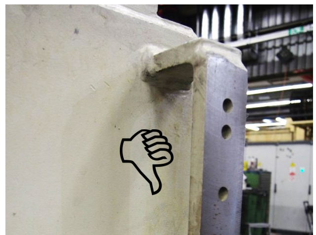
Abbildung 12 Schlechter Ansatz bzw. Kehlnahtdicke zu klein
