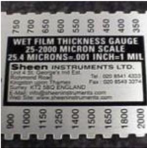
Der Nassschichtkamm wird sofort nach Auftrag der Beschichtung in die noch nasse Beschichtung senkrecht aufgesetzt.
