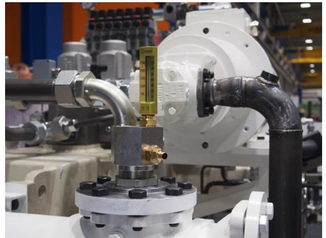
Bild 4 Wärmetauscher, bearbeiteter Rohrbogen
